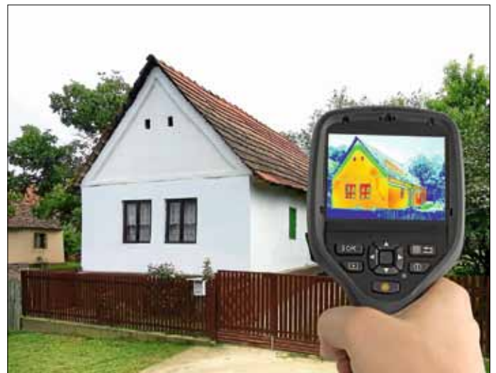
Infrarotaufnahmen entlarven Wärmelecks: Rot bedeutet Alarm!
